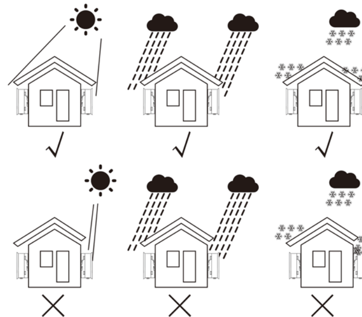
▲ Figura 4.1 Posição de instalação recomendada
